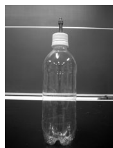
▲ペットボトルのキャップに穴を開け、空気入れのバルブを差し込みます。
