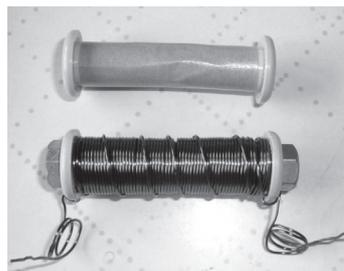
し、その熱でツバ管の両端を融かして、エナメル線を通す穴を開ける。
